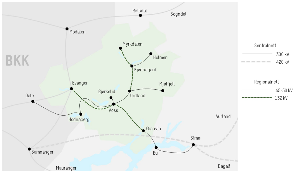
Figur 2: Oversikt over sentralnettet rundt og regionalnettet i Voss herad. Linja mellom Urdland-Kjønnergard er dimensjonert for 132 kV, men driftast på 50 kV. Linja mellom Kjønnergard og Myrkdalen er dimensjonert for 132 kV, men er drifta på 22 kV.
